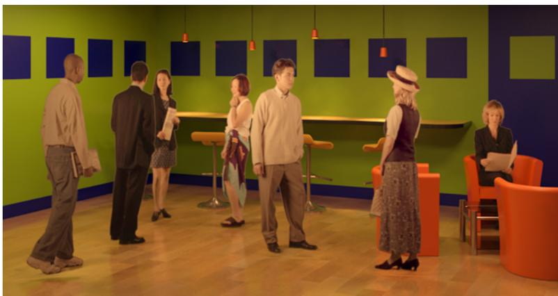
В семействе антуража Revit для моделей людей файл RPC можно использовать для задания визуального образа. Можно разместить модели людей на планах этажей и в 3D видах, где каждая модель человека представлена заполнителем. (Данные модели не отображаются на видах фасадов и в разрезах.) При визуализации 3D вида модели людей отображаются более подробно.
