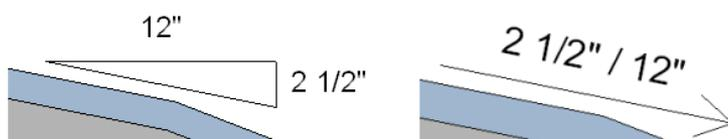
Чаще всего уклоны в точке проставляются на таких объектах, как крыши, балки и трубопроводы.
