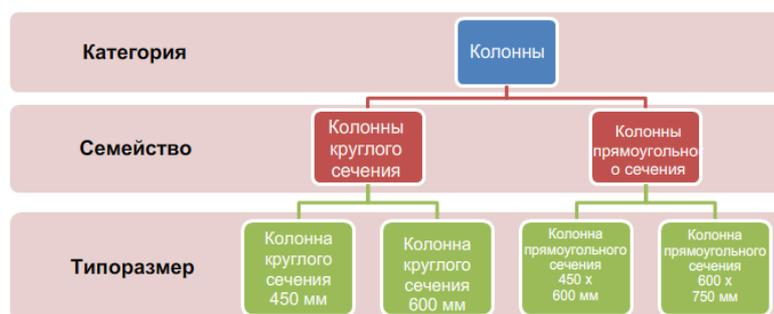
**категория** Функциональная область (такая как несущие конструкции, механическое оборудование, электрооборудование или архитектура) или специализация (например, архитектура, проектирование зданий и сооружений или строительство).
