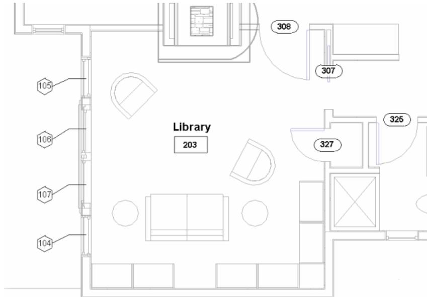
Каждой категории в библиотеке семейств назначена марка. Одни марки автоматически загружаются вместе с предустановленными шаблонами Revit Architecture, другие требуется загружать самостоятельно. При необходимости с помощью редактора семейств можно создавать пользовательские марки. См. раздел [Создание семейства аннотационных обозначений](#) на стр. 999.
