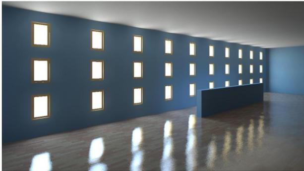
Световые фонари используются только в видах интерьеров, включающих солнечный свет. Поэтому в диалоговом окне "Визуализация" в разделе "Освещение" для параметра "Схема" необходимо выбрать значение "Внутри: только солнце" или "Внутри: солнце и искусственный свет". (См. раздел [Управление освещением в визуализированном изображении](#) на стр. 1154.)
