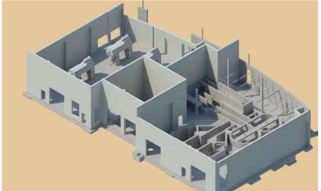
实体和渠首工程结构 Revit Structure 模型。
