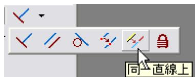
19. 「同一直線上」の拘束を使って、2番目の点が法線上に載るようにします。
