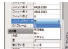
ノート パラメータの設定変更ができます (AutoCAD LT 2012 では参照のみ)
