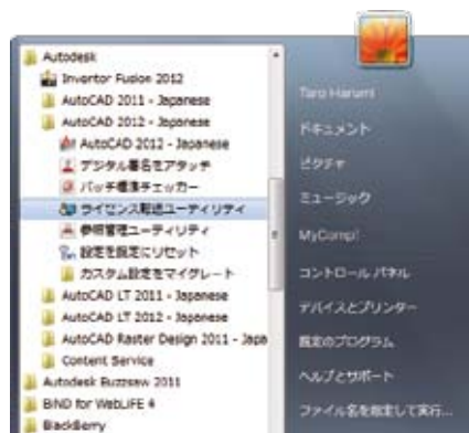
Windowsのスタート メニューからオンライン ライセンス転送ユーティリティを実行
