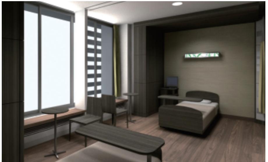
BIMデータを元にして、仕上げの色・テクスチャ、家具も加えた3Dイメージ。病室のデザインをわかりやすく施主に伝える。
