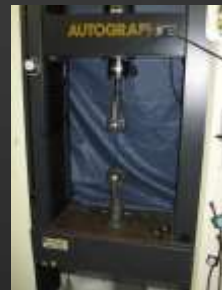
万能試験機 材料の引張、圧縮、曲げ強度測定
