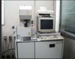
PVT測定装置 加圧時のプラスチックの密度を測定
