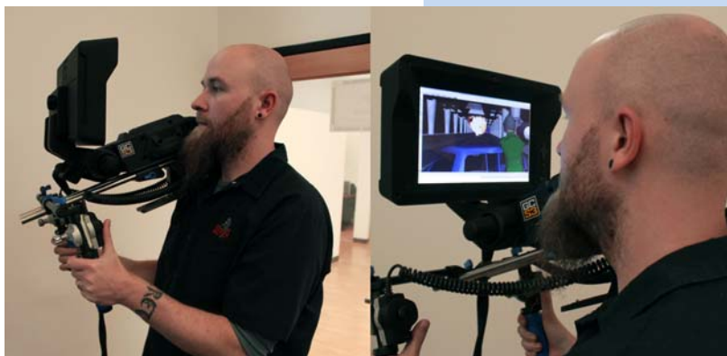
図 5c Justin Denton のスーパーバイザー Halon Previs は、Camecaster GCS3 バーチャルカメラコントローラを使用。撮影したものがリアルタイムで Maya で 3DCG として確認できる。
