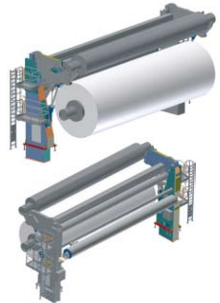
Baugruppe einer Papiermaschine, konstruiert mit Autodesk Inventor (Bild: ISM Kirschbaum)
