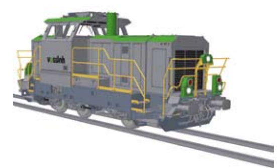
Mit Autodesk Inventor konstruiert: Lokomotive von Vossloh. Rund ein Viertel aller Teile einer Lokomotive sind Blechteile. Die Prozesskette bis hin zum Laserschneiden erweist sich dabei als besonders ökonomisch, da sie viele Arbeitsgänge einsparen hilft (Bild: Vossloh Locomotives)
