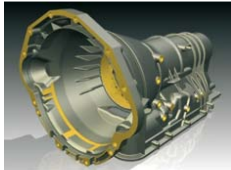
Komplexes Gussgehäuse, konstruiert mit Autodesk Inventor, in fotorealistischer Darstellung
